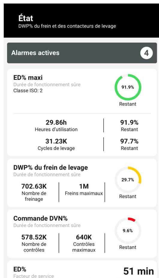
Lorsqu'un composant est neuf, il affiche 100 % (durée de vie prévue). À mesure que le palan est utilisé, l'opérateur commencera à recevoir des avertissements de service pour remplacer les éléments d'usure courants ou effectuer l'entretien régulier si nécessaire. L'utilisation derrière les avertissements de service conduit également au calcul de la durée de vie prévue globale.
